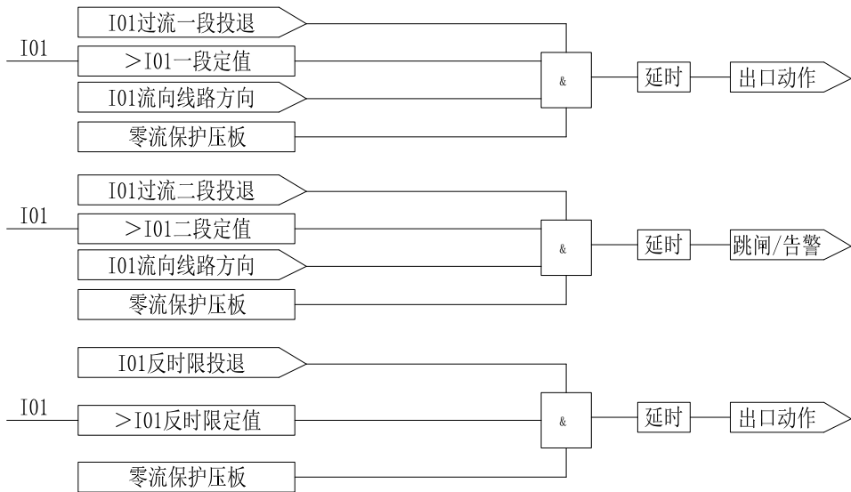
图 2.8 两段式零序 I01 过流/I01 反时限过流保护逻辑
